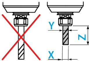
**Der Schneidendurchmesser des Werkzeuges (X) darf nicht größer sein als der maximale Spannbereich (Y).**
